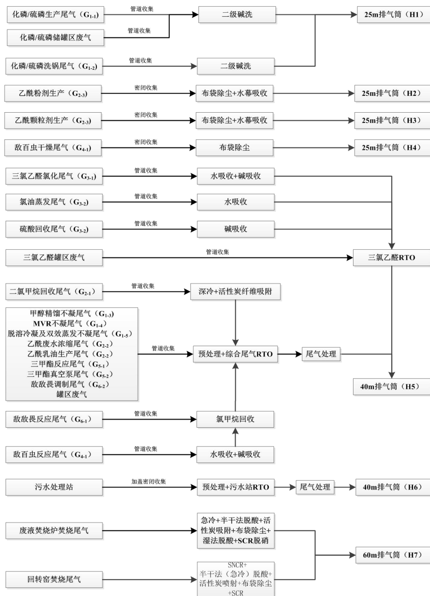
图 8-1 废气收集处理措施示意图
