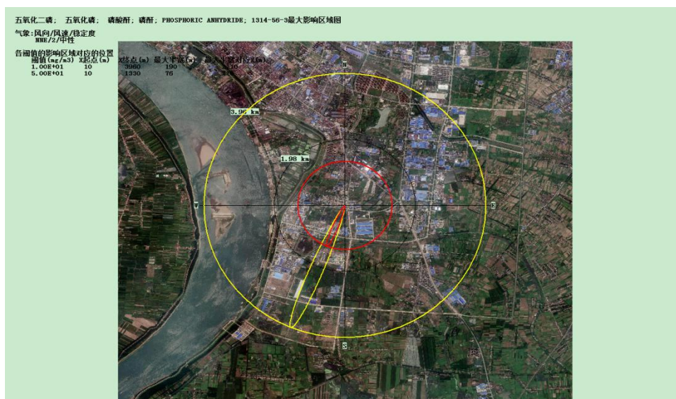
图 7-19 黄磷储罐火灾伴生/次生事故最常见气象预测结果
