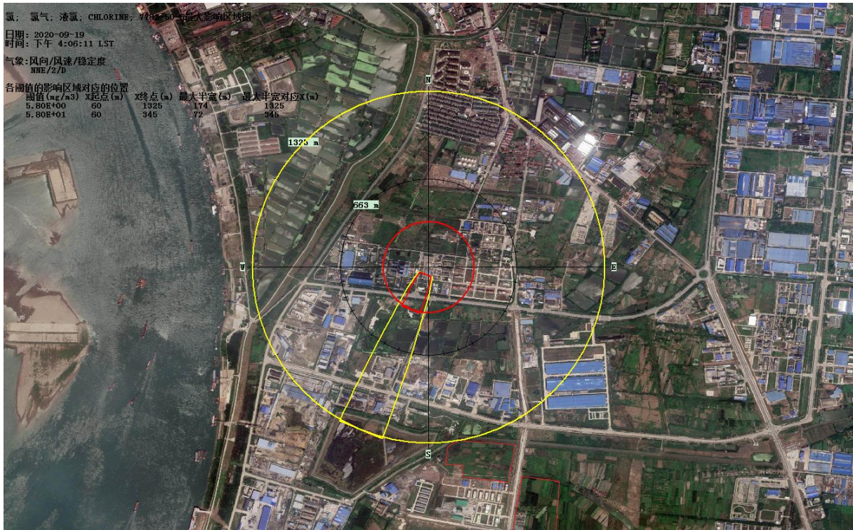
图 7-4 最常见气象条件氯气泄漏事故超过阈值最大轮廓
